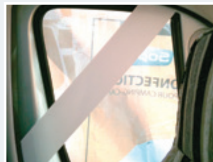
Instalación mediante elástico en las puertas para las perfiladas
