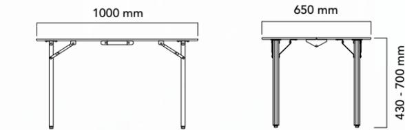
Avec le modèle FLEX BAMBOU, nous avons relevé le défi de concevoir une **vraie table robuste** allant jusqu'à 4 personnes avec un encombrement minimal.
